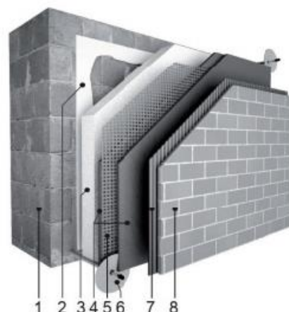
Pav. 6. Išorinės sienos, šiltinamos išorėje ir klojamos apdailos plytelėmis, schema
