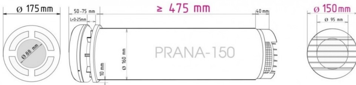
Mini rekuperatoriaus principinė schema
