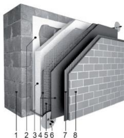
Pav. 6. Išorinės sienos, šiltinamos išorėje ir klojamos apdailos plytelėmis, schema
