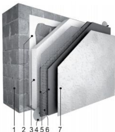
Pav. 5. Išorinės sienos, šiltinamos išorėje ir tinkuojamos plonasluoksniu tinku, schema
