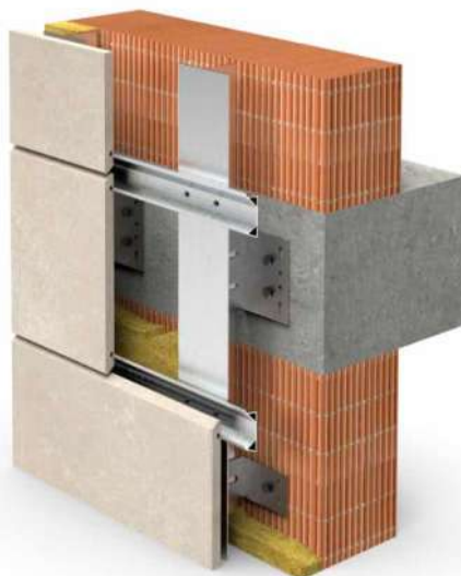
2 pav. Fasadinių plytelių tvirtinimo schema
