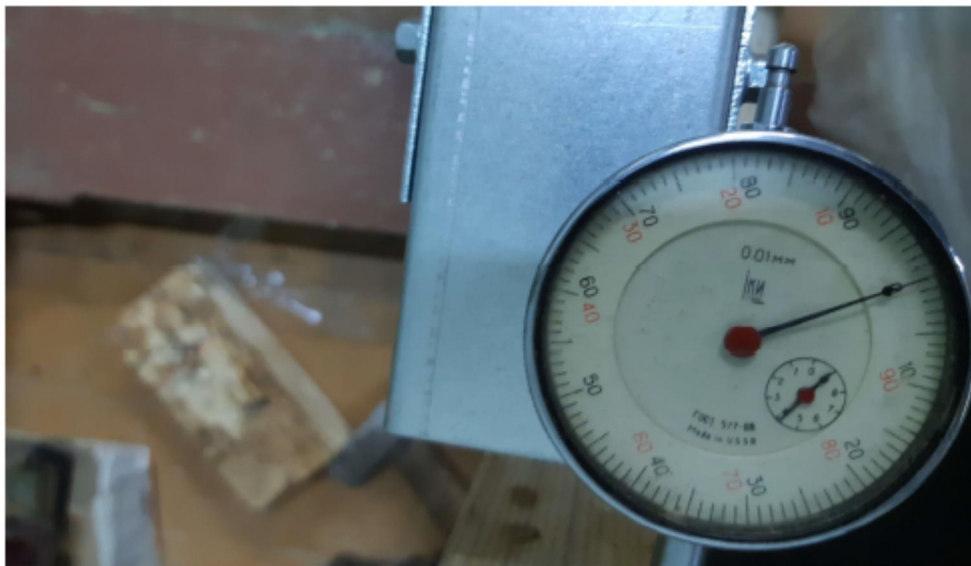
4 pav. Deformacija išmatuota poslinkio indikatoriumi.
