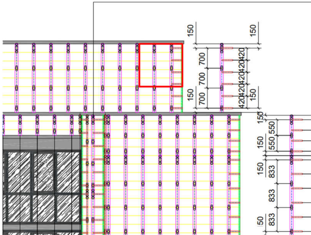
Fasado kronšteinų išdėstymas pastato kampų zonose (ašys B-A)
