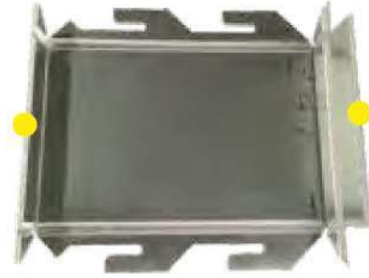
Pav. 4 Viršutinių ir apatinių kraštinių lankstymas 90 laipsnių
