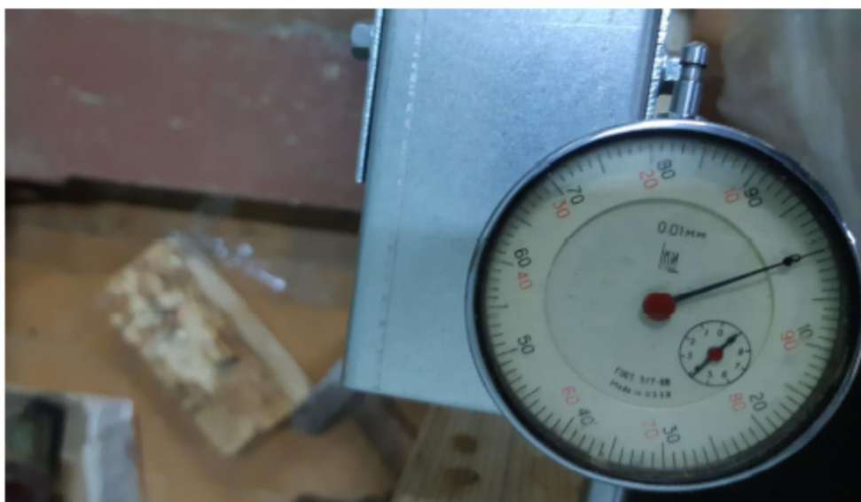
4 pav. Deformacija išmatuota poslinkio indikatoriumi.
