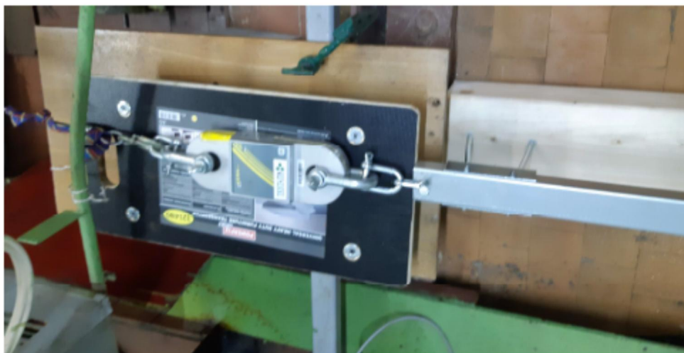
3 pav. Tempimo jėga išmatuota skaitmeniniu dinamometru.
