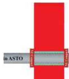
Priešgaisrinės apkabos montavimas per sieną.
