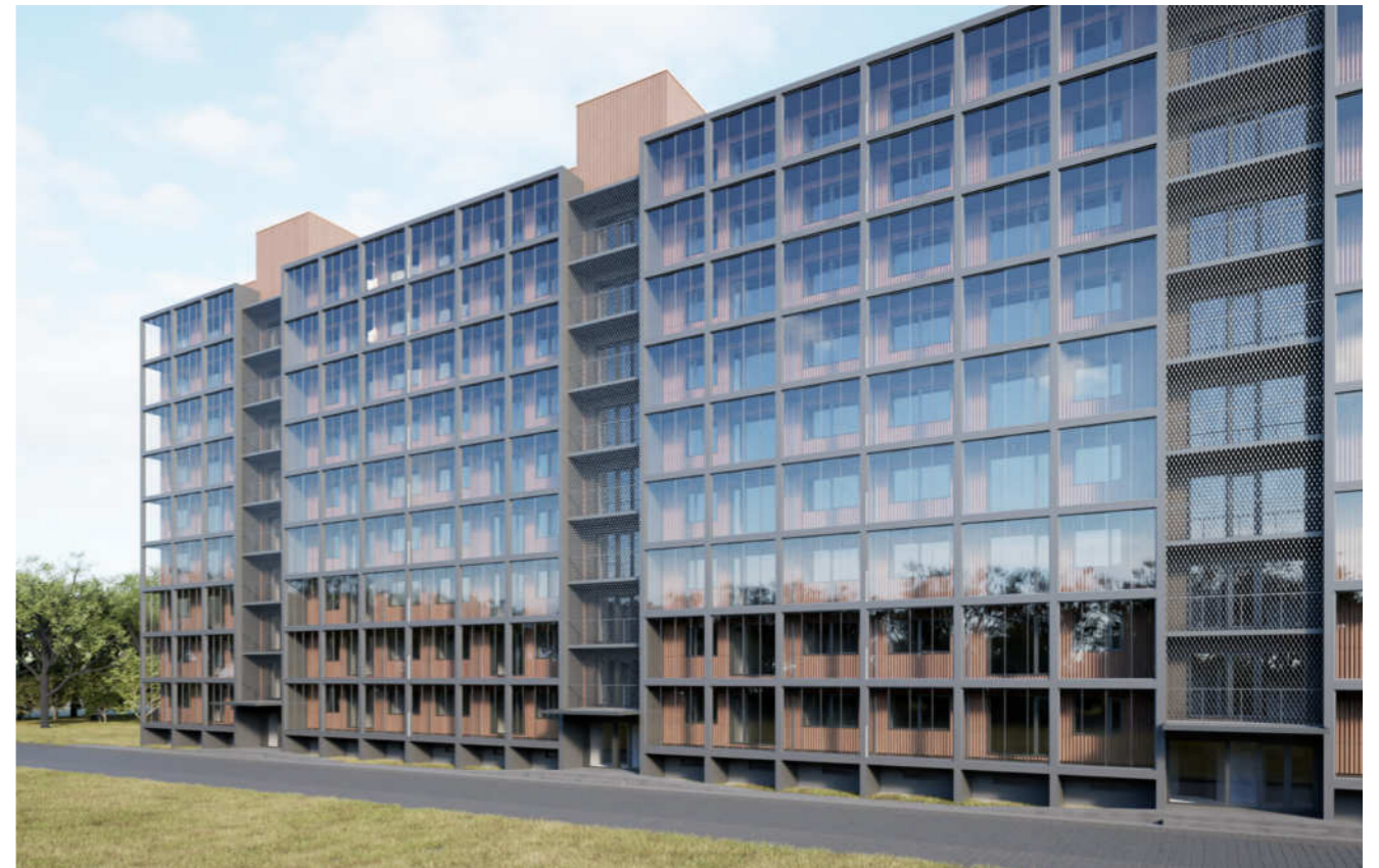
Vizualizacija: 1-464LI serijos 9 a. pastato prieigų fasadas, vietoje dekoratyvios betono plokštės, montuojamas ažūrinis nerūdijančio plieno tinklo (balkonų) fasadas
