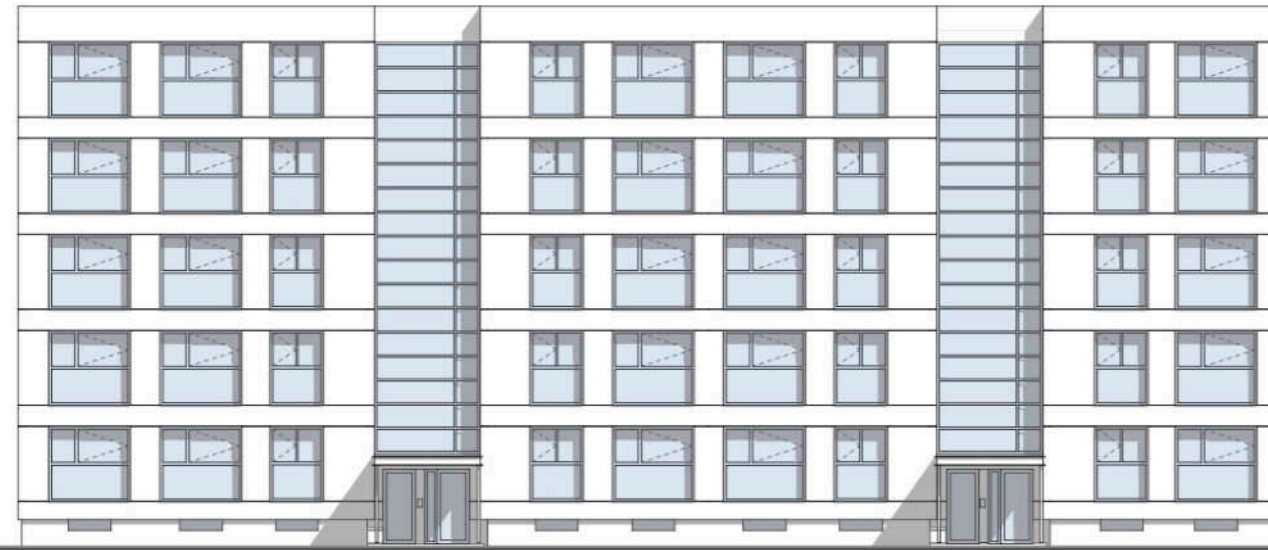
Fasado schema: langų sudalinimo variantas Nr. 12 PASTABA: visi langai varstomi į vidų
