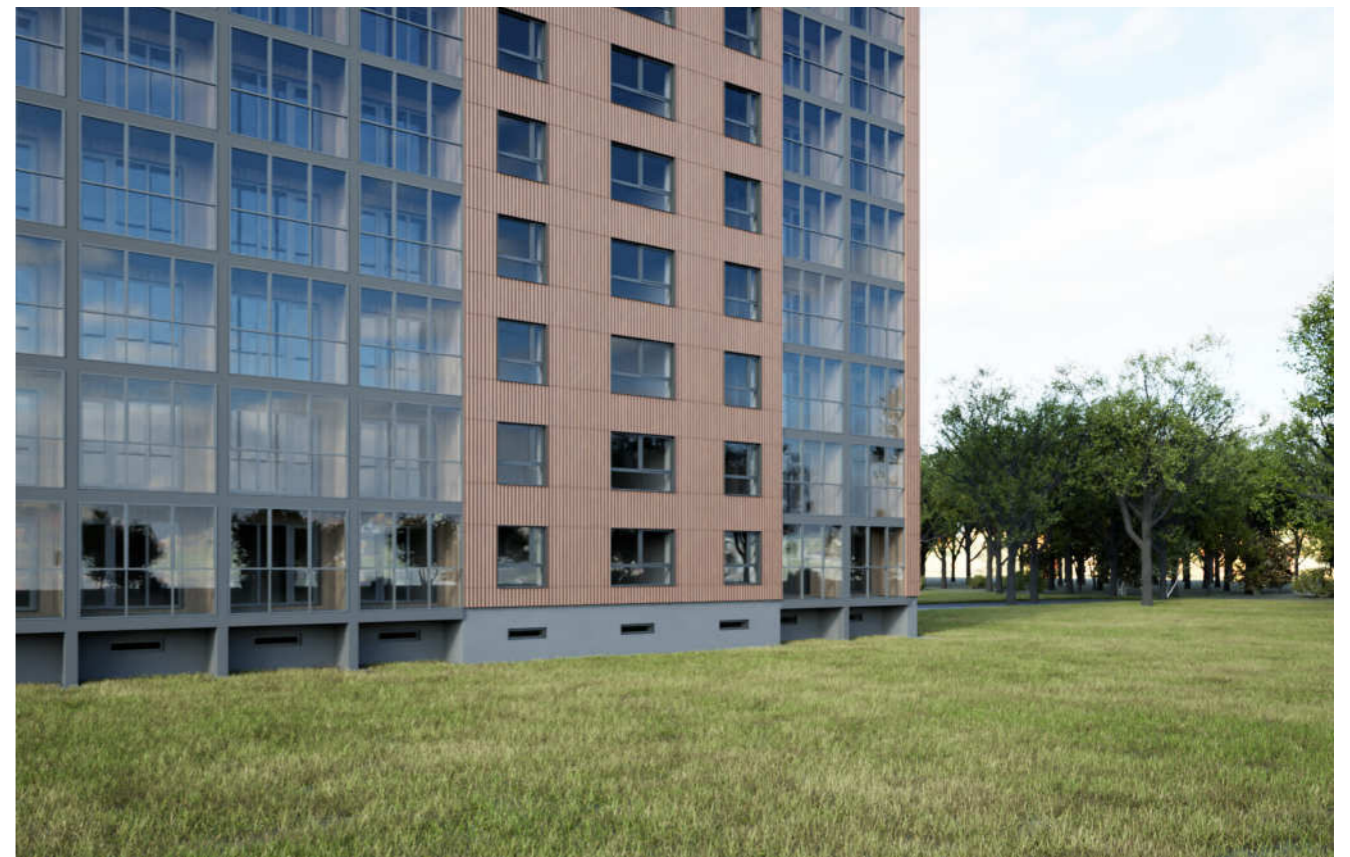
Vizualizacija: 1-464LI serijos 9a. pastato nepadintų lodžijų stiklinimas šilta sistema, turėklo funkciją atlieka fiksuota apatinė stiklinimo sistemos dalis
