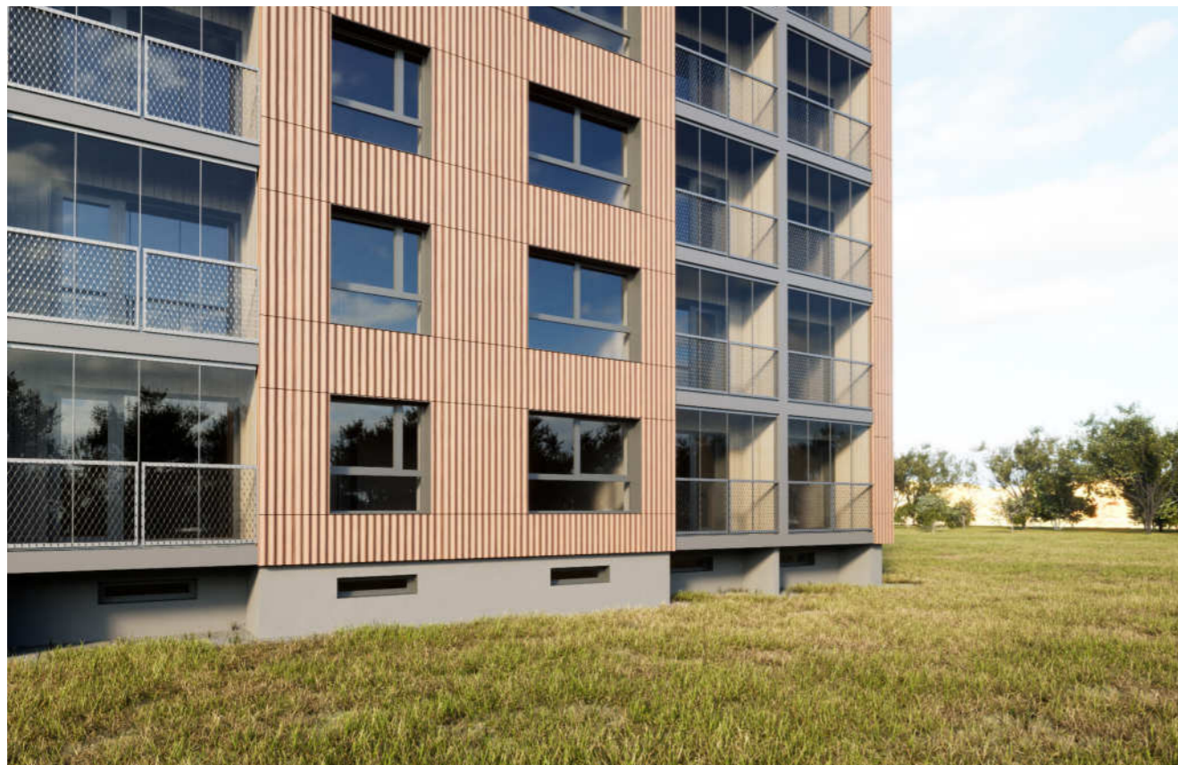
Vizualizacija: 1-464LI serijos pastato nepadidintų lodžijų stiklinimas šalta berėme sistema, iš išorės montuojami nerūdijančio plieno tinklo turėklai
