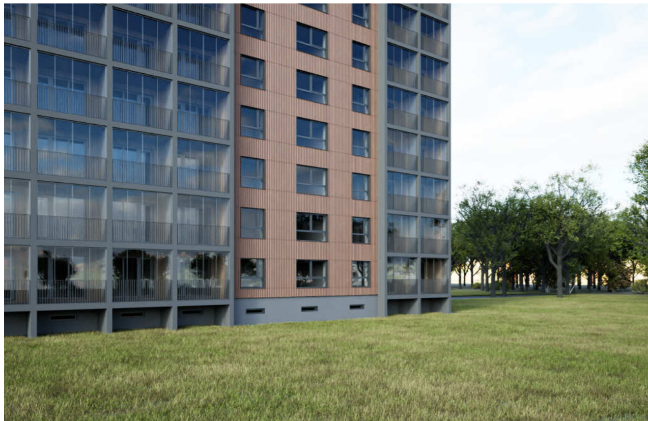
Vizualizacija: 1-464LI serijos 9a. pastato padinintų lodžijų stiklinimas šalta berėme sistema, lodžijų šonai uždari, iš išorės montuojami vertikalių metalo juostų turėklai
