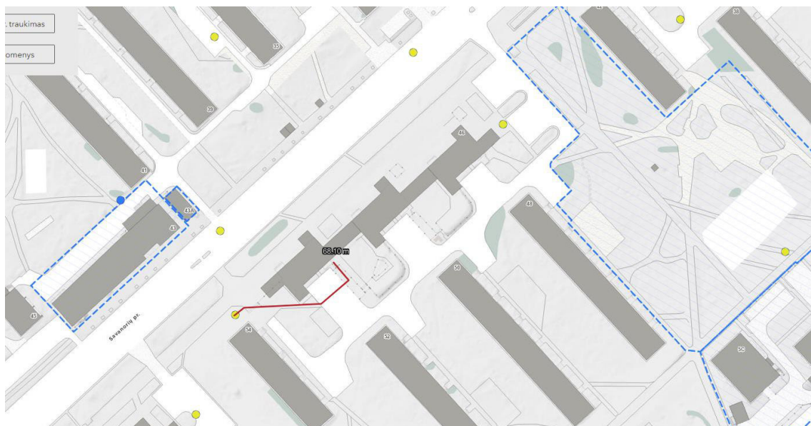
Pav. 8. Aplink modernizuojamą pastatą esantys hidrantai ( https://maps.vilnius.lt/teritoriju-planavimas )
