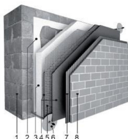
Pav. 4. Išorinės sienos, šiltinamos išorėje ir klojamos apdailos plytelėmis, schema
