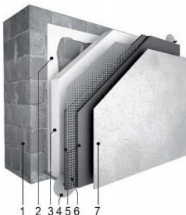
Pav. 3. Išorinės sienos, šiltinamos išorėje ir tinkuojamos plonasluoksniu tinku, schema
