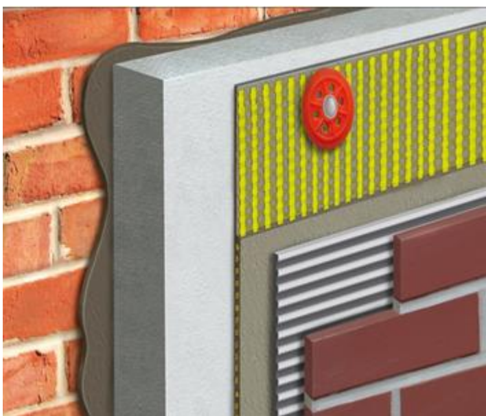
18 pav. Plokštės visada papildomai mechaniškai tvirtinamos smeigiuojant per tinklą, šlapiuoju būdu
