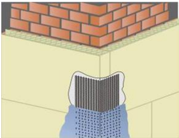
14 pav. Papildomas kampų armavimas, panaudojant kampinį profiliuotį
