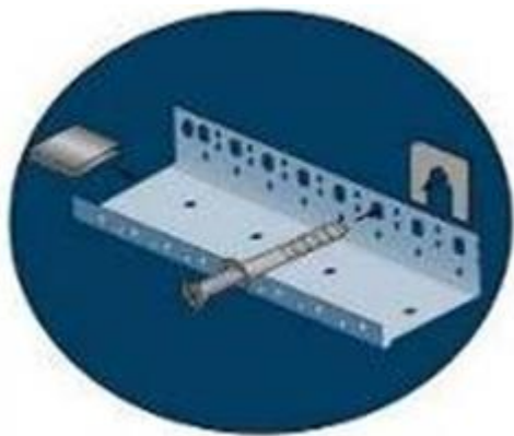
3 pav. Cokolinių profiliuotųjų tvirtinimas
