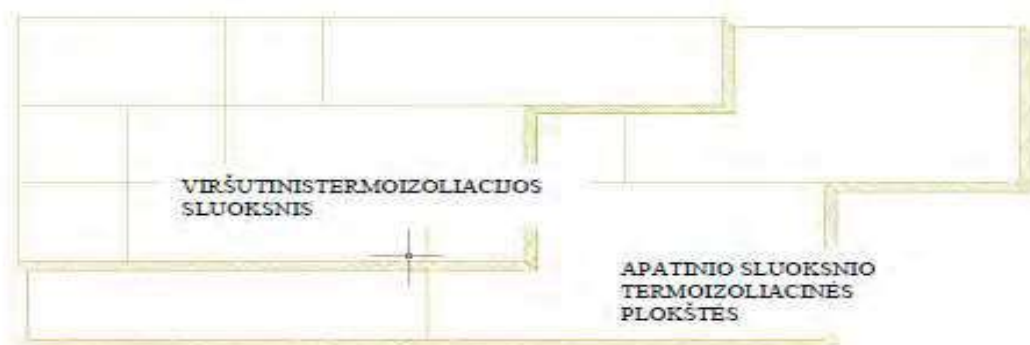
Termoizoliacinių plokščių slinktis klojant viršutinį ir apatinį sluoksnius.
