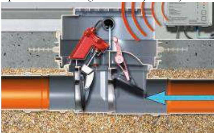
2 pav.: pradėjus nuotekoms tekėti atgal au tomatiškai užsidaro darbinis uždoris. Skydelyje suveikia optinė ir akustinė signalizacijos.
