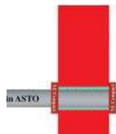
Priešgaisrinės apkabos montavimas per sieną.
