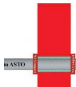
Priešgaisrinės apkabos montavimas per sieną.
