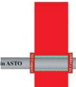
Priešgaisrinės apkabos montavimas per sieną.
