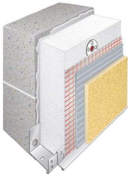
Pav.4 „Tipinis išorinės tinkuojamos sudėtinės termoizoliacinės sistemos su EPS vaizdas“
