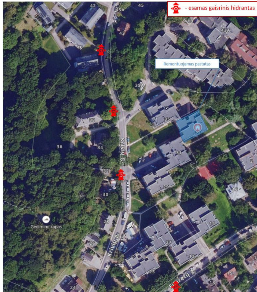
2 pav. Artimiausi šalia projektuojamo pastato esantys hidrantai
