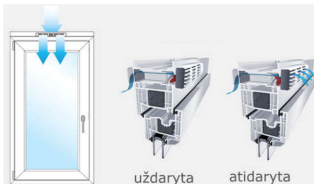
7 pav. Orlaidės lango/stiklinimo profilyje pavyzdys
