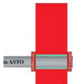
Priešgaisrinės apkabos montavimas per sieną.
