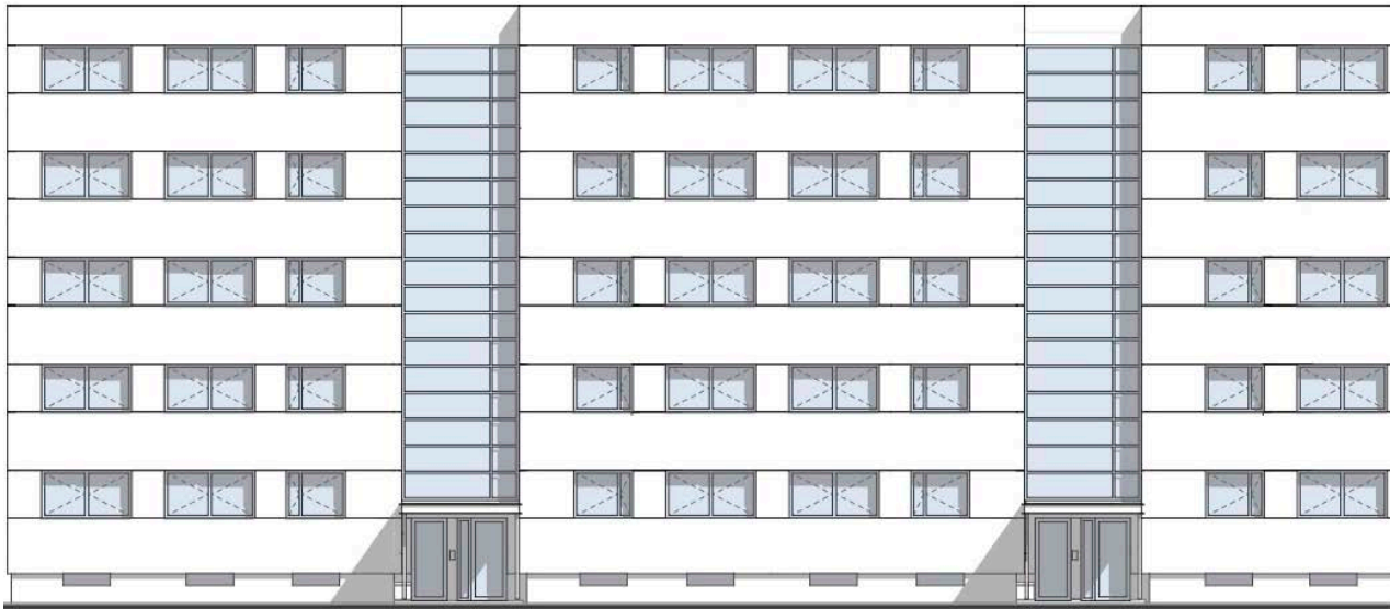
Fasado schema: langų sudalinimo variantas Nr. 3 PASTABA: visi langai varstomi į vidų
