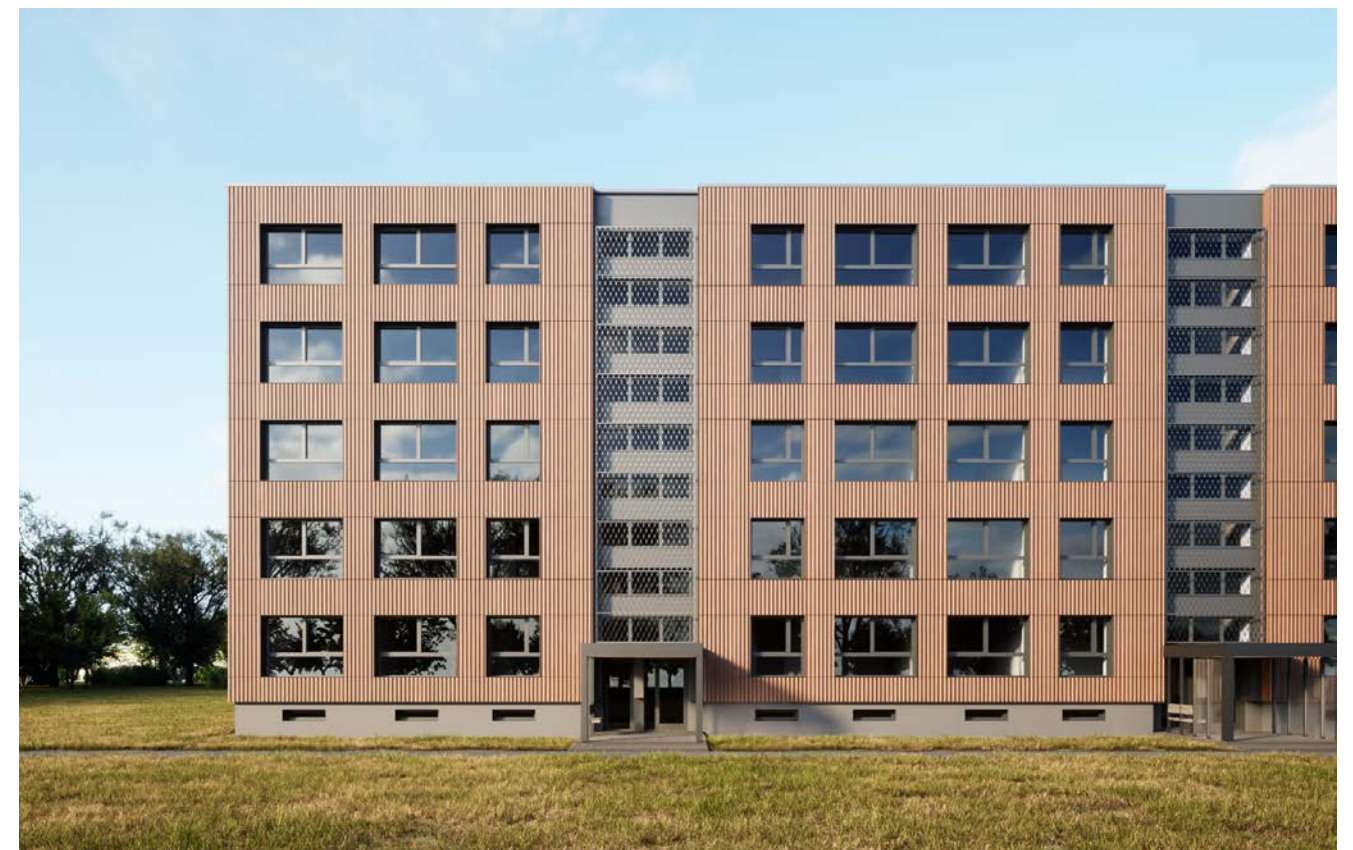
Vizualizacija: 1-464LI serijos pastato prieigų fasadas, nepadidinti laiptinių langai, langų nišos suformuojamos iki parapeto viršaus (sudalinamas pastato tūris), uždengiamos plieno tinklu
