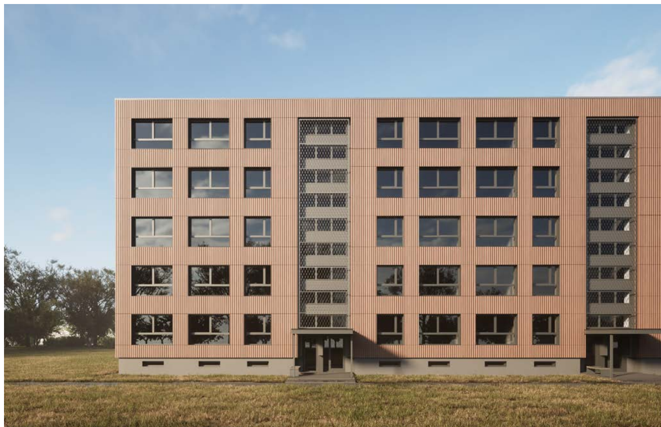
Vizualizacija: 1-464LI serijos pastato prieigų fasadas, nepadidinti laiptinių langai, langų nišos uždengiamos azūrinio plieno tinklu
