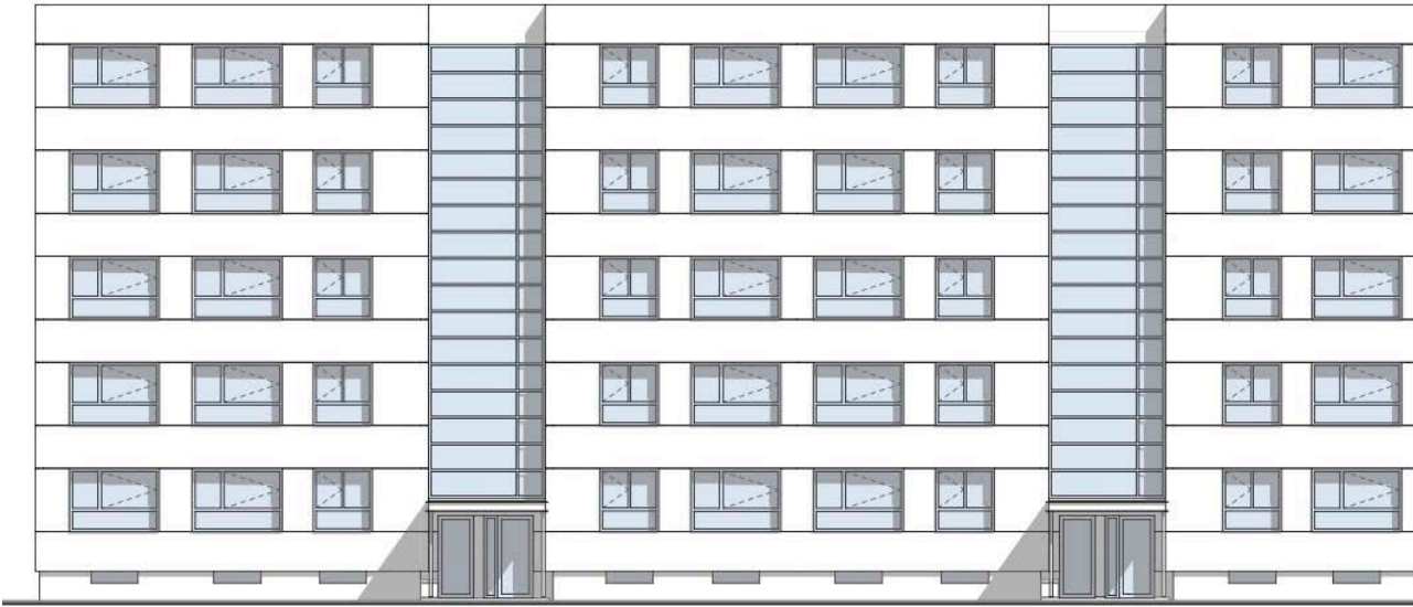
Fasado schema: langų sudalinimo variantas Nr. 6 PASTABA: visi langai varstomi į vidų
