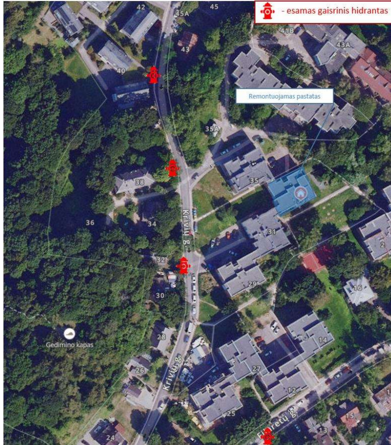
2 pav. Artimiausi šalia projektuojamo pastato esantys hidrantai
