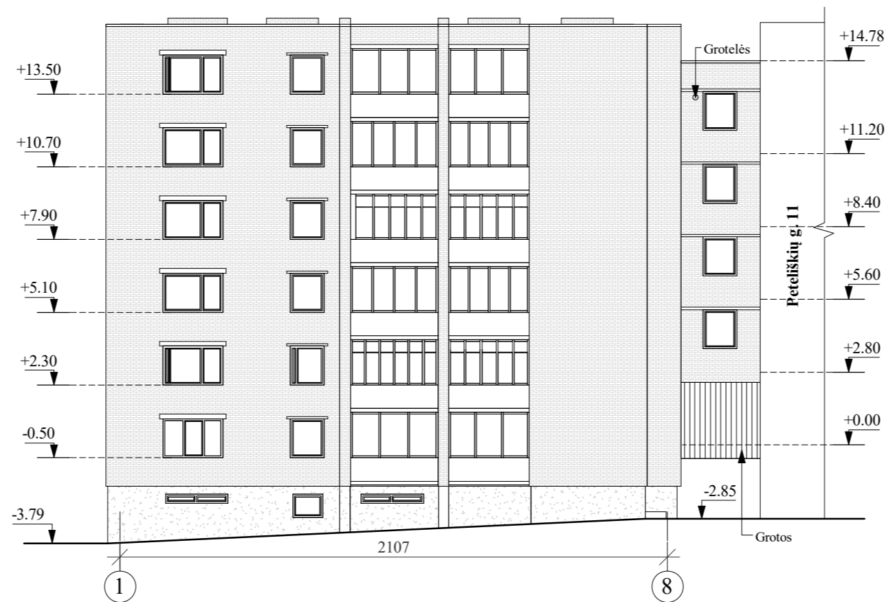
FASADAS TARP AŠIŲ 1-8 M 1:200
