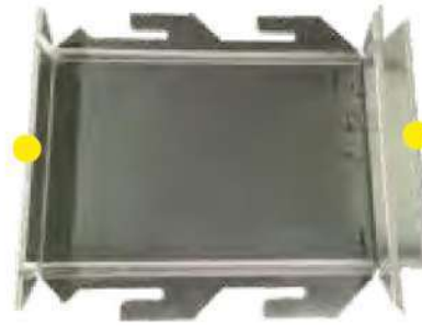
Pav. 4 Viršutinių ir apatinių kraštinių lankstymas 90 laipsnių
