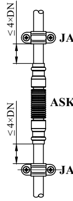
IX ašinio silfoninio kompensatoriaus montavimo schema
