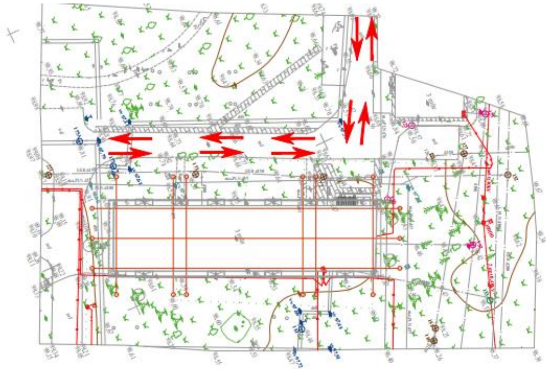
Vanduo lauko gaisro gesinimui imamas iš hidranto, nuo kurio vandens tiesimo linija 153-180m.
