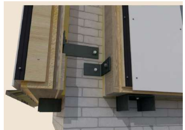
Pav. B Skydų išorinio kampo sujungimas:
