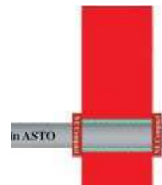
Priešgaisrinės apkabos montavimas per sieną.
