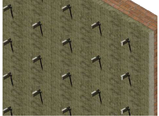
Paveikslas 8: Šilumos izoliacijos įrengimas
