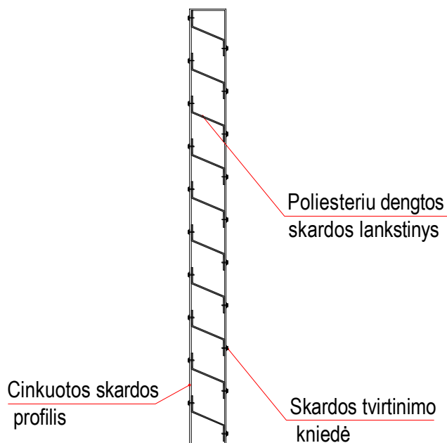
Principinis vertikalus pjūvio vaizdas iš šono
