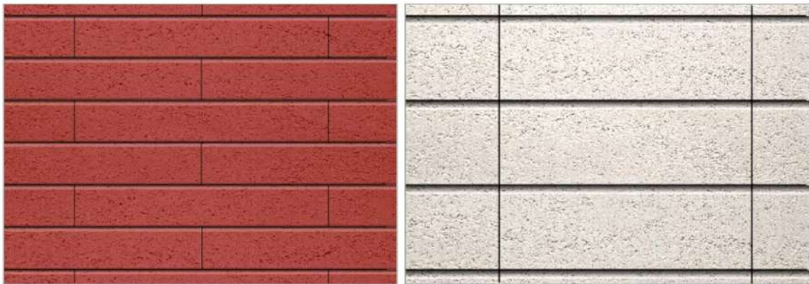
Paveikslas 9: Šachmatinis ir tolygus plytelių išdėstymas
