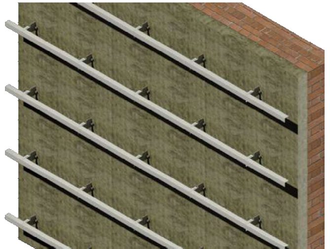
Paveikslas 6: Distancinio profilio montavimas
