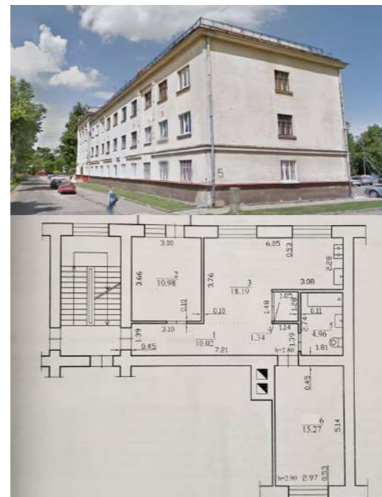
14 pav. SNIp II. B. 10-54 Normų pavyzdys: 1957 m. statybos daugiabutis Vilijampolėje, Sąjungos a., turintis stalinistinės architektūros bruožų – fasadų dekorą, erdvesnes patalpas bei aukštesnes lubas (2,9 m). Nuotr. iš aruodas.lt, maps.google.com
